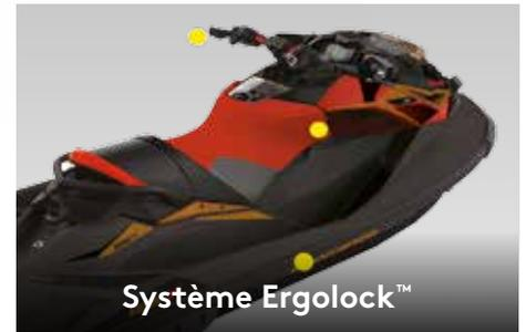
Le siège de course étroit avec cale-genoux plus profonds assure une assise naturelle et permet aux conducteurs de mieux manœuvrer en serrant les muscles des jambes pour plus de contrôle.
